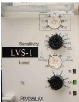
Многофункциональное реле **RM35LM**, работает в автоматическом режиме.
