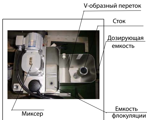
Рис. 4 Дозирующая емкость и емкость флокуляции
